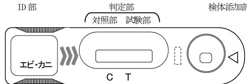
テストプレートは検体を添加する検体添加部、判定を行う判定部、検体名等を記入する ID 部から構成されています。さらに判定部は、甲殻類（えび類、かに類）由来タンパク質の判定を行う試験部（T）、対照ラインの確認を行う対照部（C）からなっています。
